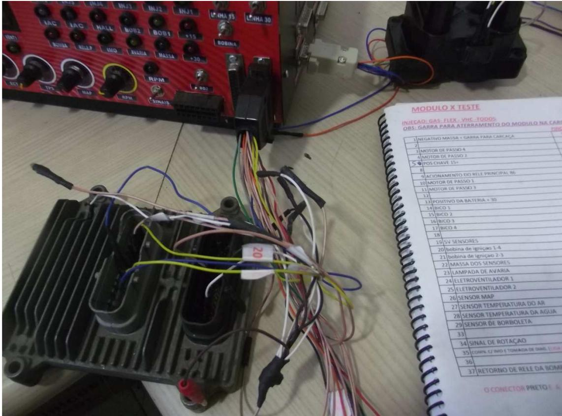
**VHC:** Este modulo mesmo sem o sistema de Imobilizador, a bobina de ignição entra em funcionamento. Não esquecer de colocar a garra de aterramento na carcaça do modulo .
