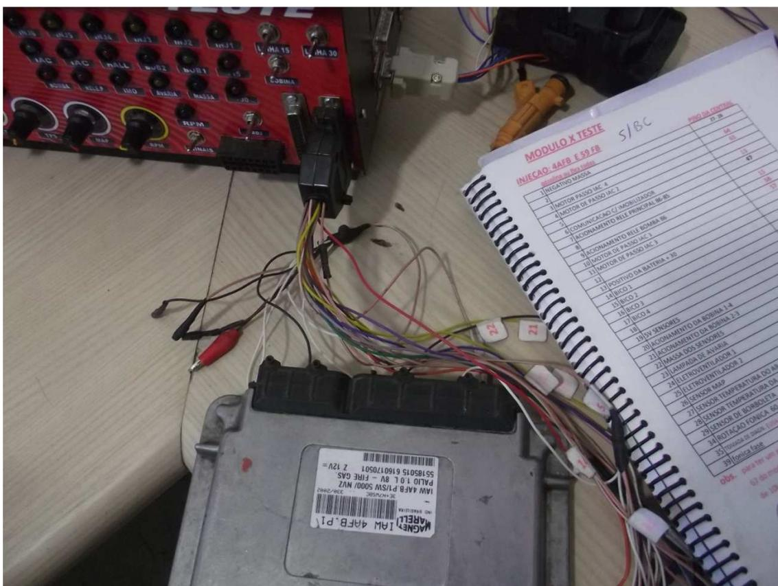
**4 AFB :** Esse modulo estando codificado não entra em funcionamento. Fazer decode , será necessário colocar bobina de ignição para teste mais preciso.
