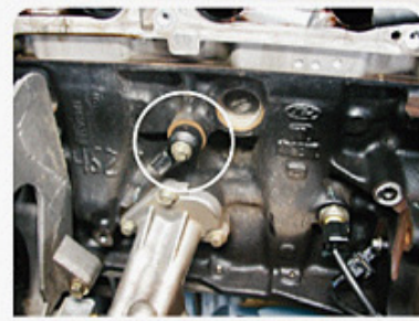
F14 - Localização do KS, coletor removido
