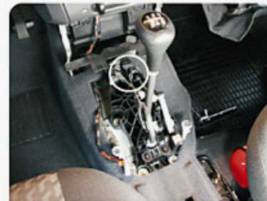
F30.3 - Aterramento T-13
