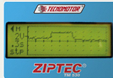
Sinal de resposta do sensor de pressão após uma aceleração.
