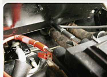
F.2.2 - Procedimento de medida da resistência do secundário da bobina de ignição.
