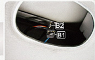
Borne B de aterramento da luz interna.
