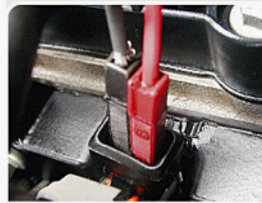
F.1.1 - Procedimento de medida da resistência elétrica do eletroinjeter.
