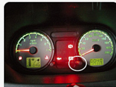
F.1 - Tecla de RESET do hodômetro parcial
