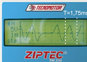
Sinal do sensor de posição da árvore de manivelas (CKP) em marcha lenta.
