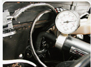
F.2.3 - Bomba de pressão instalada.
