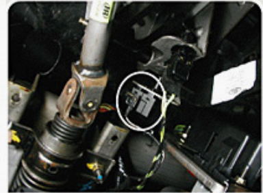
Localização do sensor CPP: fixado no pedal de embreagem.
