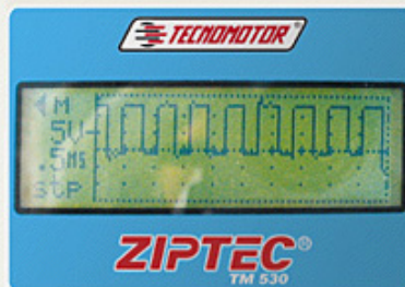
Sinal de alimentação do atuador de marcha lenta após uma aceleração.
