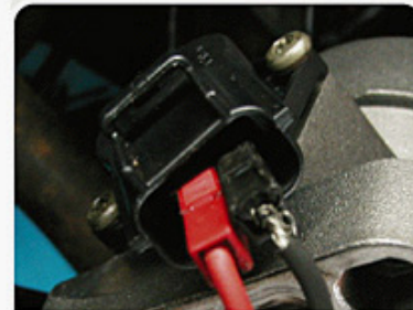
E.3.1. - Procedimento para medir a resistência elétrica do sensor TPS.
