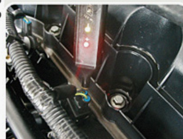
E.3.2 - Procedimento de verificação dos pulsos durante a partida.
