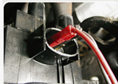
E2.1 - Procedimento de medida da resistência do primário da bobina de ignição.
