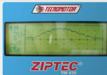
Sinal de resposta do sensor de posição da borboleta após acelerar e desacelerar.
