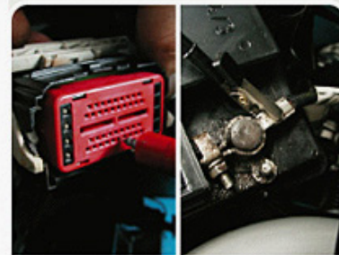
F.1.1. - Procedimento de medição da tensão de alimentação direta da bateria.
