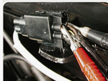
F.1.1 - Medida da tensão de resposta do sensor HEGO.
