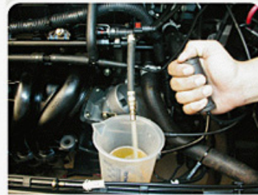
F.1.4 - Procedimento de medição da vazão de combustível.
