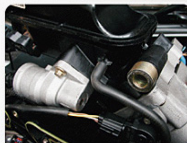
F6.1 - IAC: interno à curvatura do coletor
