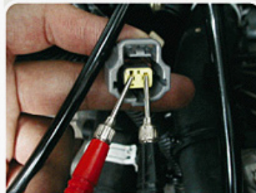
F.2.1 - Procedimento para medir a tensão de alimentação do sensor ECT.
