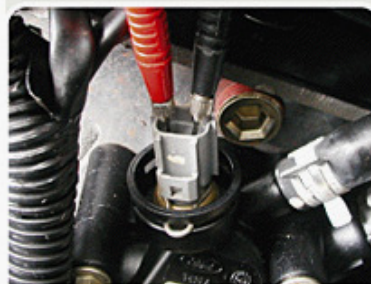
F.3.2 - Procedimento para medir a resistência do sensor ECT.
