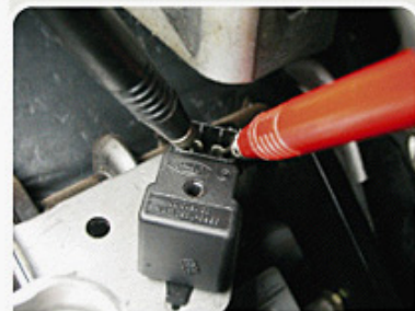
F.2.1 - Medição da resistência no próprio sensor.
