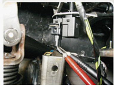
F.1.1 - Medida do sinal do sensor CPP com o pedal da embreagem não pressionado.
