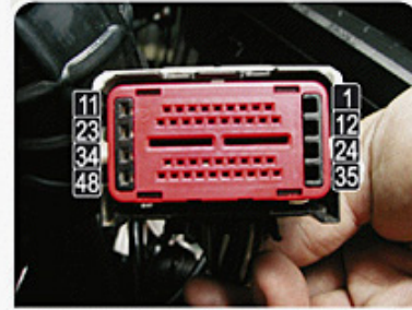
Terminal elétrico A do MC.
