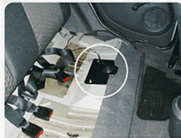
Localização da bomba de combustível.
