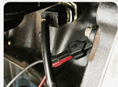
F.2.1 - Procedimento de medida da resistência do sensor CKP.
