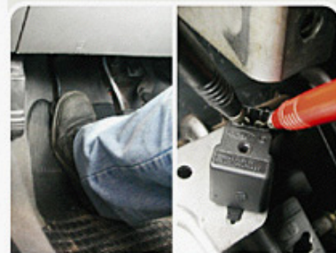
F.2.3 - Medida da resistência do sensor CPP com o pedal da embreagem pressionado.
