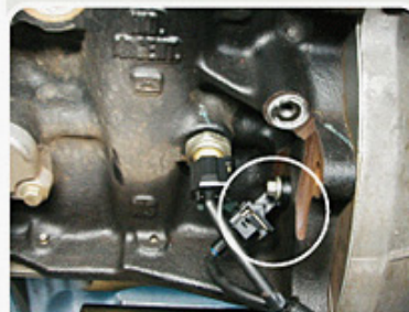
Localização do terminal elétrico do sensor CKP.
