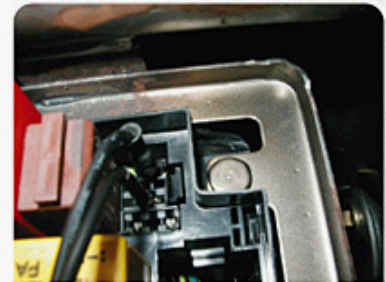
F10.1 - Curto entre os terminais 3 e 5 do soquete do relé da bomba
