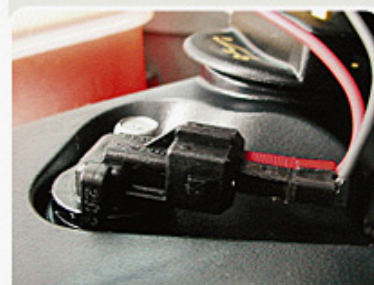
F.2.1 - Procedimento de medida da resistência do sensor CMP.
