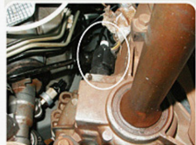
Localização do sensor VSS: próximo ao catalizador, por baixo da proteção metálica.
