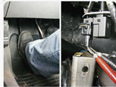
F.1.3 - Medida do sinal do sensor CPP com o pedal da embreagem pressionado.
