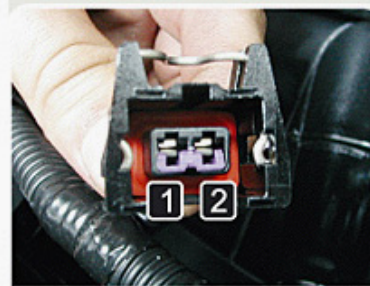
Terminal elétrico dos eletroinjetores.
