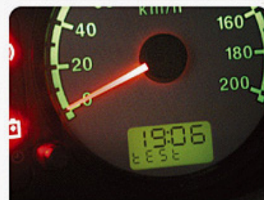
F.2 - Painel de Instrumentos no modo de Auto Diagnóstico
