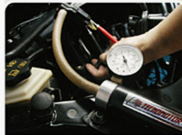
F.5.3 - Medição da tensão da resposta de pressão
