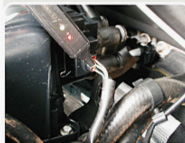
F.4.2 - Procedimento de verificação dos pulsos enviados pelo MC durante a partida.
