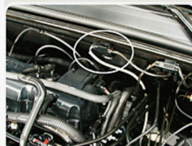
Localização do terminal elétrico do sensor HEGO.
