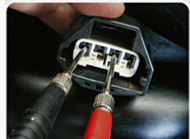
F.3.1 - Procedimento da medida da tensão de alimentação do sensor CMD.
