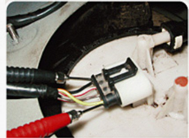
F.3.2 - Procedimento de medida da tensão de alimentação da bomba de combustível.
