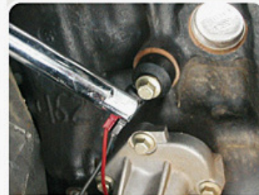
E1.2 - Batida no sensor KS com uma haste metálica.
