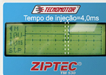
Sinal do pulso de acionamento do eletrôinjeter em marcha lenta.
