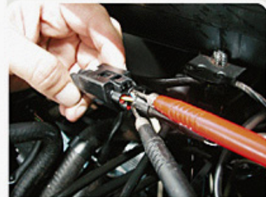
F.1.2 - Procedimento de medida da frequência do sinal do sensor VSS.
