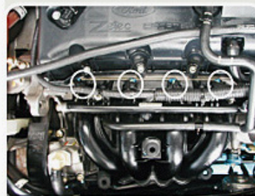
Localização dos eletroinjetores.
