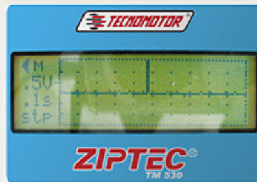
Pico de tensão gerado por uma batina no sensor KS com uma haste metálica.
