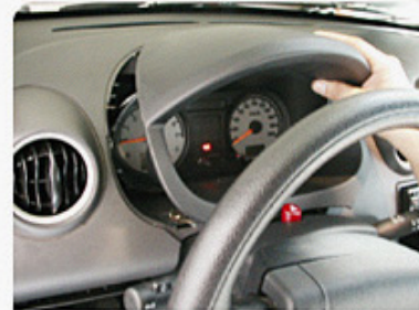
F16.1 - Remoção da cobertura do painel
