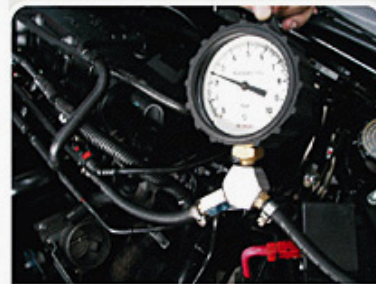
F.2.4 - Pressão de alimentação da bomba de combustível.
