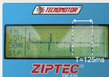
Sinal do sensor de posição do comando de válvulas (CMP) em marcha lenta.
