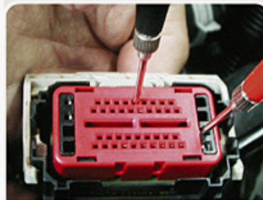
F.3.1 - Procedimento da medida da resistência do atuador IAC.
