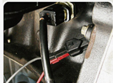
F.1.2 - Procedimento de medida da tensão de resposta do sensor CKP.
